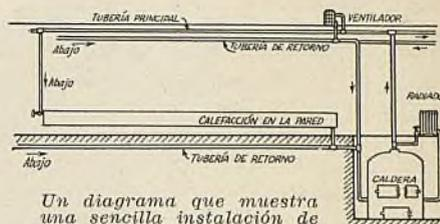
Un diagrama que muestra una sencilla instalación de calefacción de vapor de baja presión. Como se ve, la corriente de vapor y la condensación de la misma siguen siempre una dirección descendente, excepto en la salida de la caldera.
