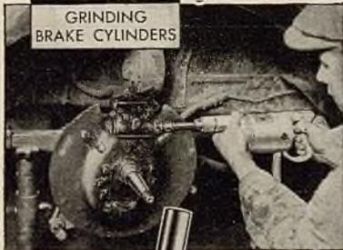
Se ahorra tiempo y trabajo en las reparaciones de frenos usando los esmeriladores Ammco. Escala de 1/4" a 1 3/4".
