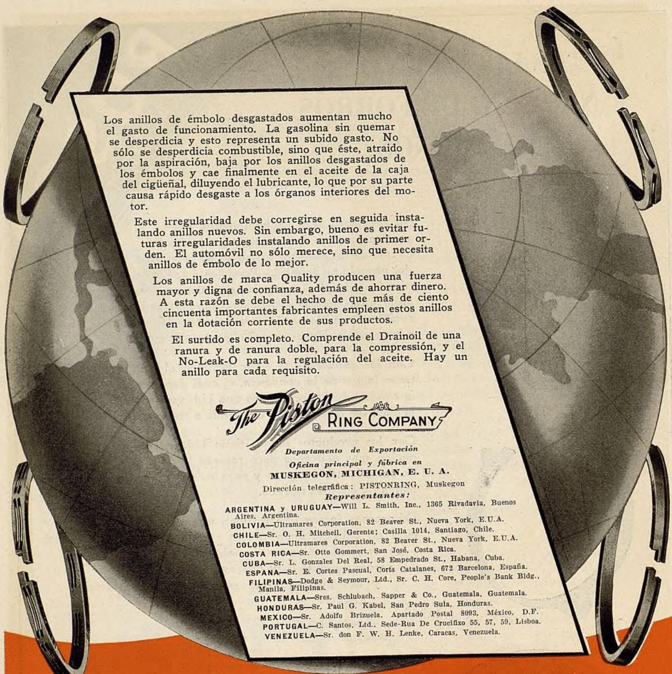
Los anillos de émbolo desgastados aumentan mucho el gasto de funcionamiento. La gasolina sin quemar se desperdicia y esto representa un subido gasto. No sólo se desperdicia combustible, sino que éste, atraído por la aspiración, baja por los anillos desgastados de los émbolos y cae finalmente en el aceite de la caja del cigüeñal, diluyendo el lubricante, lo que por su parte causa rápido desgaste a los órganos interiores del motor.
