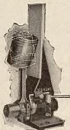
El rectificador de alineación de émbolo Stevens asegura una comprobación rápida y exacta del grupo de émbolo. El indicador "Sea Lion" verifica perfectamente la posición del pasador en relación con la biela. Acusa toda desviación o deformación de la biela. Los ejes están esmerilados con suma precisión y tienen abrazaderas para su fijación y cambio. Cada eje tiene 0,02 de pulgada de sobretamaño para asegurar un ajuste apretado.
