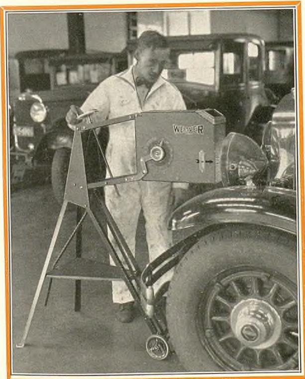
Aumenta el número de personas que exigen el ensayo de los faros, por saber los motoristas que los faros bien ajustados son esenciales para la seguridad en el manejo. El nuevo Probador de faros Weaver proporciona por primera vez un medio rápido para enfocar y proyectar la luz de los faros con precisión científica. Puede usarse en todas partes, con la luz del día.
