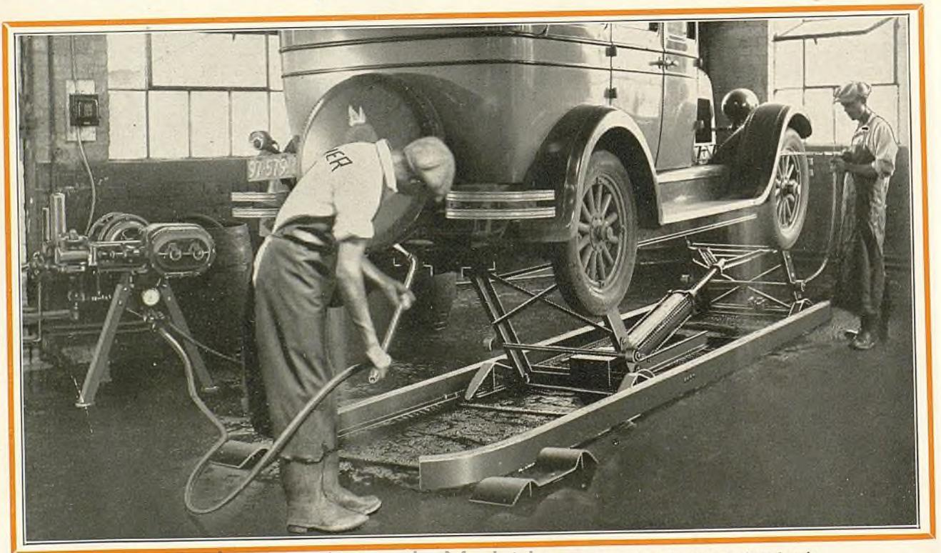
Para el lavado de coches por el sistema moderno, es menester disponer de un aparato elevador de coches y de una máquina lavadora Weaver. El tiempo que economizan muy pronto recompensa su costo. La lavadora Weaver suministra enseguida cualquier clase de chorro, ya se trate de un chorro grueso y potente a alta presión para quitar el barro y suciedad, o bien de un leve rocío.
