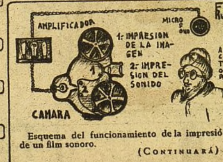
Esquema del funcionamiento de la impresión de un film sonoro. (CONTINUARÁ)
