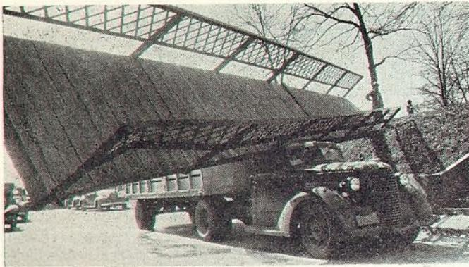
**CAMION ESPACIOSO** ... (izquierda). Este camión para muebles, con garita encima del motor, está construido sobre un chasis Ford y emplea doble eje trasero, fabricado por la Perfection Steel Co. de Gallion, Ohio. Entre el eje delantero y el eje doble trasero hay un compartimiento colgante que mide 9 pies de largo, 12 pulgadas de alto y 30 pulgadas de fondo.
