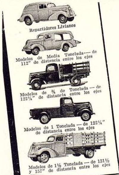
Camiones para concordar exactamente con sus requisitos de transporte o de reparto, pueden elejirse de este surtido de 5 diferentes capacidades de carga
