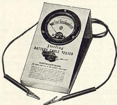
Nokrode. Los comerciantes podrán ahora mostrar a los dueños de automóviles el descenso exacto de voltaje entre el acumulador y el cable, determinando en esa forma, de manera definitiva, el estado del cable de acumulador. Además de estar calibrado en milivoltios C.D., la carátula del medidor está dividida en áreas verdes, amarillas y rojas indicando si el cable está en buenas, medianas o malas condiciones.
