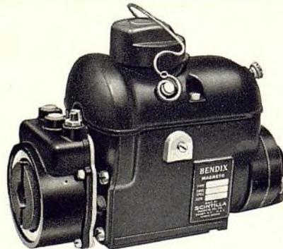
Los magnetos Bendix-Scintilla se suministran para toda clase de motor de uno a seis cilindros, de tipos de automóvil, industriales y marinos. Ventajas como imanes giratorios, bobinas fijas impermeables, ruptores sin pivotes y piezas móviles tapadas, permiten a estos magnetos dar un funcionamiento irrefragable y de gran duración.
