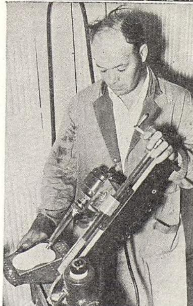
**LA ACCION DE LA EXPLOSION** se estudia mediante este aparato usado en los laboratorios de la Chevrolet. El aparato corta secciones esféricas sucesivas de un molde de yeso de una cámara de explosión modelo.
