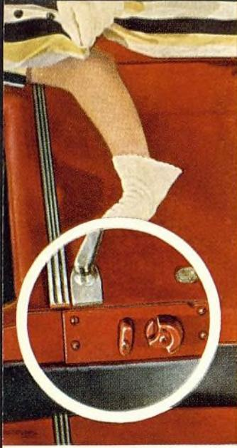
LAS PUERTAS SE CIERRAN firmemente y sin esfuerzo en todos los Studebaker 1938. La razón de ello esriba en un pivote giratorio a prueba de ruidos. Un ligero tirón de adentro o un empuje de afuera basta para cerrar la puerta.
