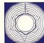
LA LINEA DE PUNTOS muestra la fuerte e irregular presión que en el interior del cilindro ejercen los anillos de extensión de tipos antiguos — de 0 a 12 libras. La línea negra indica la leve pero firme presión del X-90.
