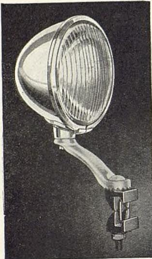
de cromo, y de forma perfilada para hacer juego con el estilo de los automóviles modernos. También pueden proporcionarse de acero esmaltado. Se puede obtener ajuste horizontal de círculo completo por medio de grasas. El lente convexo color de ambar permite un máximo de transmisión de luz.
